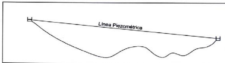
FIG. 2 - LINEA POR GRAVEDAD - TUBERIA A PRESION
